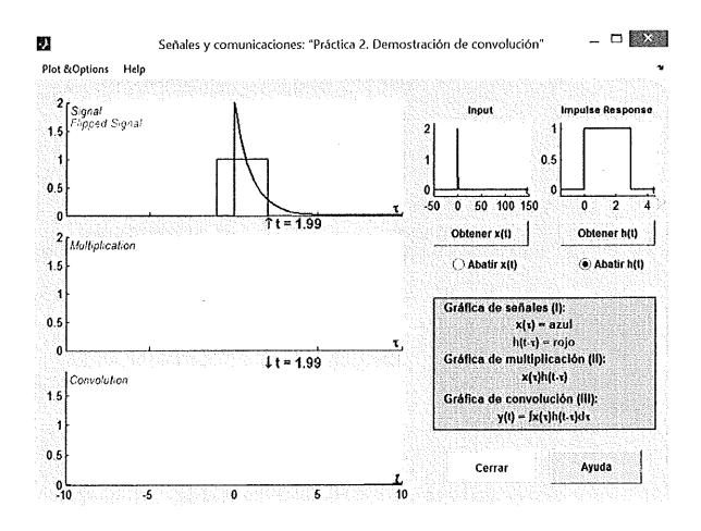
*Cuestión L2*. Sean dos señales de longitud finita (distintas de cero en un intervalo de tiempo finito y continuo)  $x_1(t)$  y  $x_2(t)$  y sea la señal y(t) la convolución de ambas:  $y(t) = x_1(t) * x_2(t)$ . ¿Cuál es la longitud de la señal y(t)?
